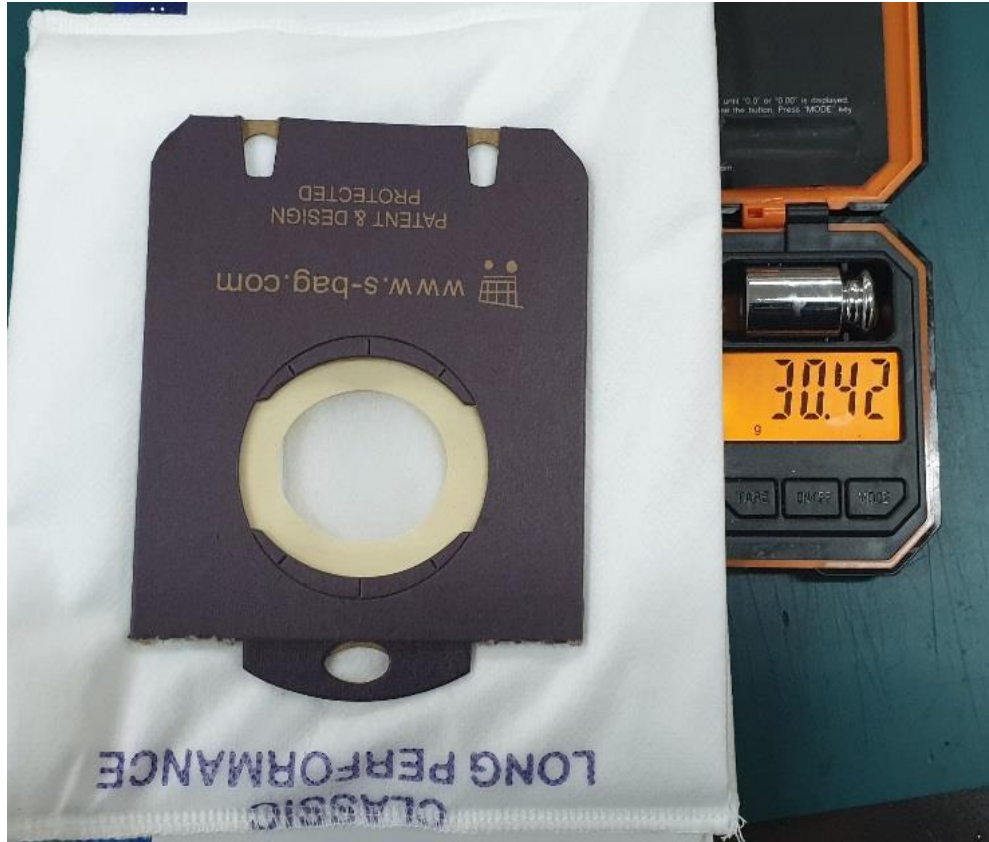
使用前灰尘袋重量: 30.42g 灰尘捕集量: 120.4g
