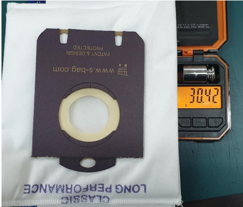
使用前灰尘袋重量: 30.42g 灰尘捕集量: 206.58g
